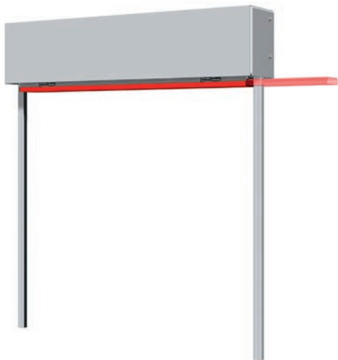
Bild 14: Veränderte Endlagenposition der Unterschiene (Unterschiene gerade), Lamellenpaket über die gesamte Breite sichtbar
